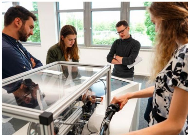
Beim Demonstrator „Zustandsüberwachung“ legen Besucherinnen und Besucher selbst Hand an: Ein Körperschallsensor überwacht akustisch das Getriebe. Bremsst man oder wechselt den Gang, gibt der Sensor Daten in Echtzeit an eine KI weiter, die anhand dieser die Zustände des Antriebes erkennt. Was hier spielerisch umgesetzt ist, sorgt z. B. in Fertigungsanlagen oder Motoren dafür, dass diese ausfallsicher und störungsfrei laufen.
